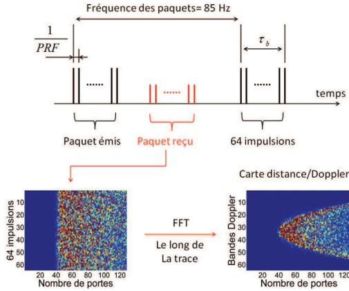
FIGURE 1 – Configuration de l'altimètre SAR/Doppler et construction de la carte distance/Doppler.
