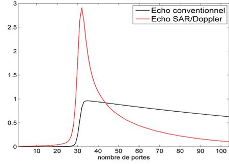
FIGURE 4 – Echos SAR/Doppler et conventionnel pour les mêmes paramètres altimétriques ( $P_u = 1$ ,  $\tau = 31$  portes et SWH = 2 m).
