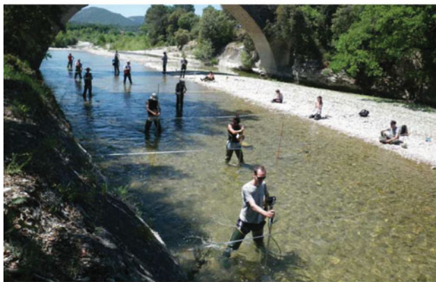
Figure 3 : Les courantomètres sur perche déployés sur l'Ouvèze à Entrechaux (2011).
