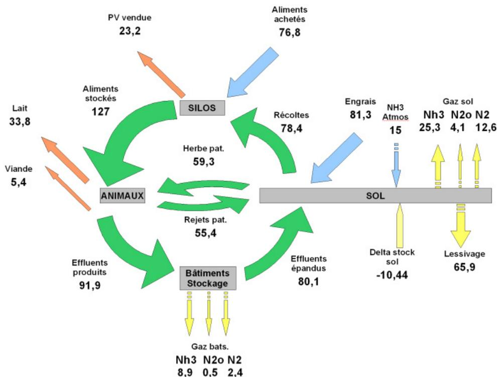
**Figure 6** : Exemple de bilan annuel du cycle de l'azote (exprimé en kg de N/ha) au sein d'une exploitation simulé par MELODIE pour une exploitation laitière avec 70% à 80% de la SAU en surfaces fourragères avec un système d'alimentation maïs/herbe.
