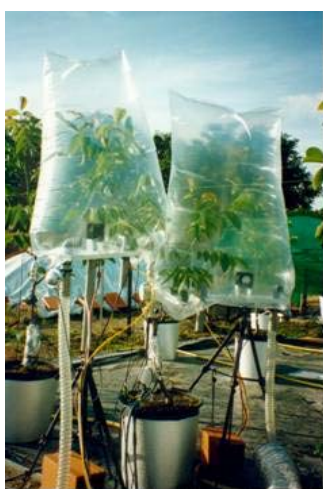
Figure 1.a : Dispositif de mesures d'échange gazeux ( \text{CO}_2 , \text{H}_2\text{O} ) sur jeune Noyer, permettant de déterminer la photosynthèse et la transpiration en conditions « naturelles ». Daudet 1987, Améglio et al. 1993.
