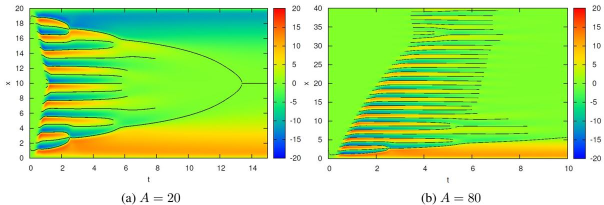
FIGURE 6 – Diagrammes spatio-temporels de la vitesse en surface libre et identification des cellules de convection,  $e = 1 \text{ mm}$  et  $\mu = 3,25 \text{ mPa} \cdot \text{s}$ .
