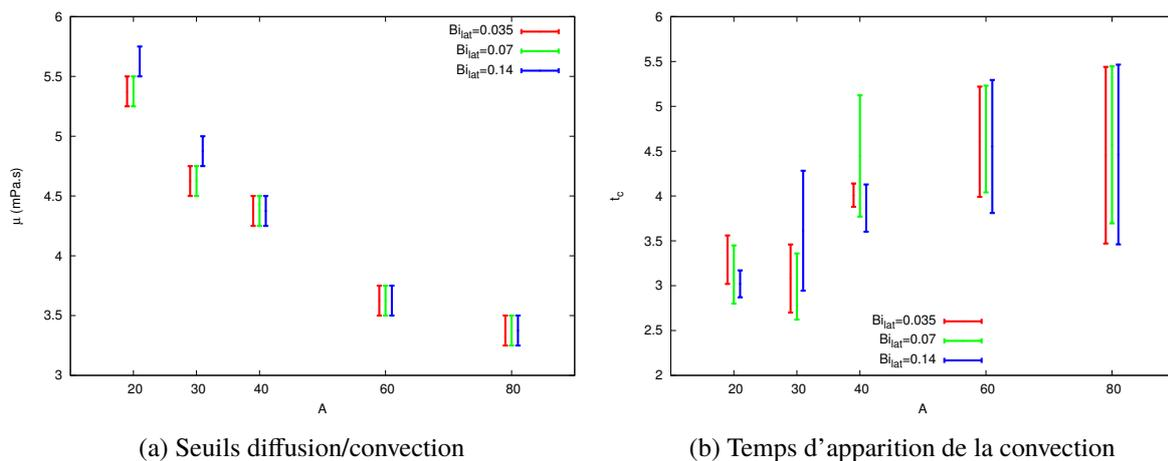
FIGURE 8 – Caractéristiques des transitions en fonction de l'allongement et du nombre de Biot latéral,  $e = 1 \text{ mm}$ .
