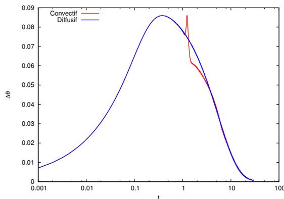
FIGURE 3 – Évolution de l'écart de température  $\Delta\theta = \theta(A/2, 0) - \theta(A/2, 1)$  dans les cas convectif et diffusif (vitesse nulle),  $e = 1\text{ mm}$ ,  $\mu = 3,25\text{ mPa}\cdot\text{s}$  et  $A = 20$ .
