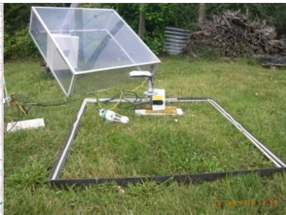
b) Dispositif de mesure – Chambre à transpiration (CETE Ile de France)
