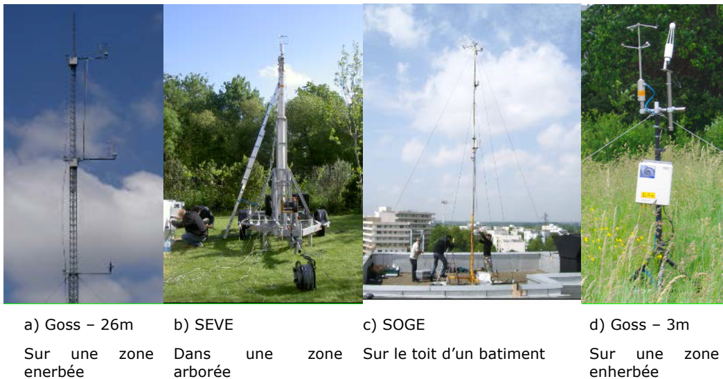
Figure 16 : Installation de mesures de flux par eddy correlation sur des mats au sol ou sur des bâtiments
