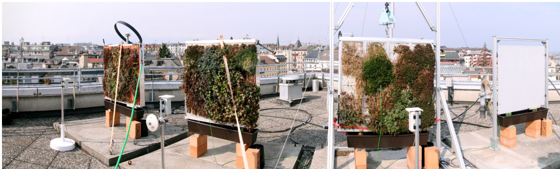
Figure 26 : Expérimentations de façades végétales utilisées pour la mise en place du modèle dans SOLENE-microclimat.
