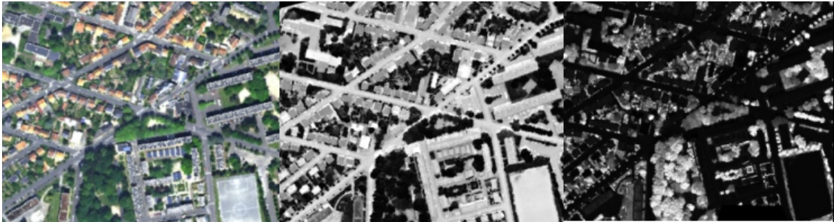
Figure 7 : Images utilisées, à gauche : composition colorée affichant les couleurs réelles ; au centre : mesure de l'angle entre chaque pixel et le spectre végétal de référence ; droite : indice utilisé.
