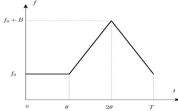
**Figure 2.** Forme d'onde FMCW avec sinusoïde pure
