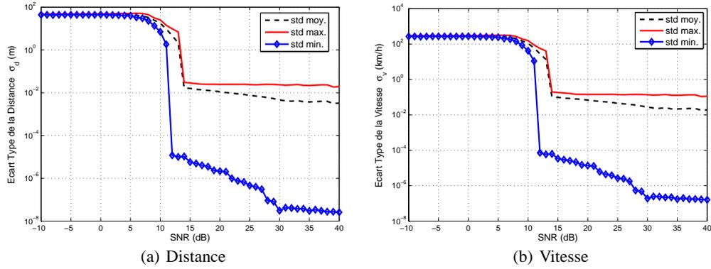
**Figure 4.** Ecart type (*std* : standard deviation) minimal, maximal et moyen pour l'estimation de la distance et de la vitesse pour la forme d'onde FMCW double pour les 35 paires  $(d,v)$ , avec  $d = 1, 50, 100, 150, 200$  m et  $v = -180, -90, 0, 90, 180, 270, 360$  Km/h.
