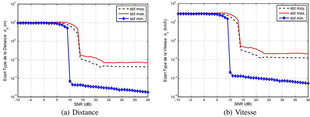
**Figure 5.** Ecart type (*std* : standard deviation) minimal, maximal et moyen pour l'estimation de la distance et de la vitesse pour la forme d'onde FMCW avec sinusoïde pure pour les 35 paires  $(d,v)$ , avec  $d = 1, 50, 100, 150, 200$  m et  $v = -180, -90, 0, 90, 180, 270, 360$  Km/h
