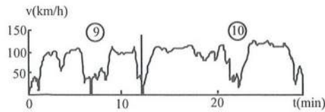
Figure 5 : Exemples de cycles de conduite : les cycles INRETS n° 9 et 10 (représentatifs des conditions de circulation autoroutières)
