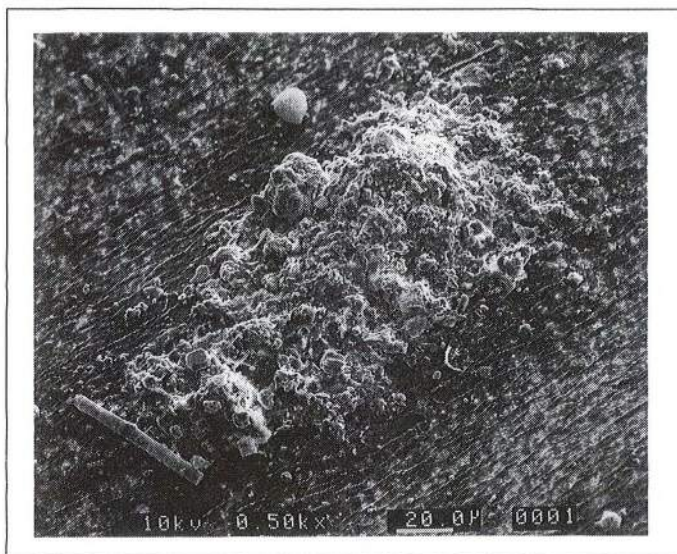
Figure 4: Photographie au microscope électronique à balayage d'un floc prélevé dans un rejet de temps sec en Seine (Pont de Sèvres), CERAM-ENPC.
