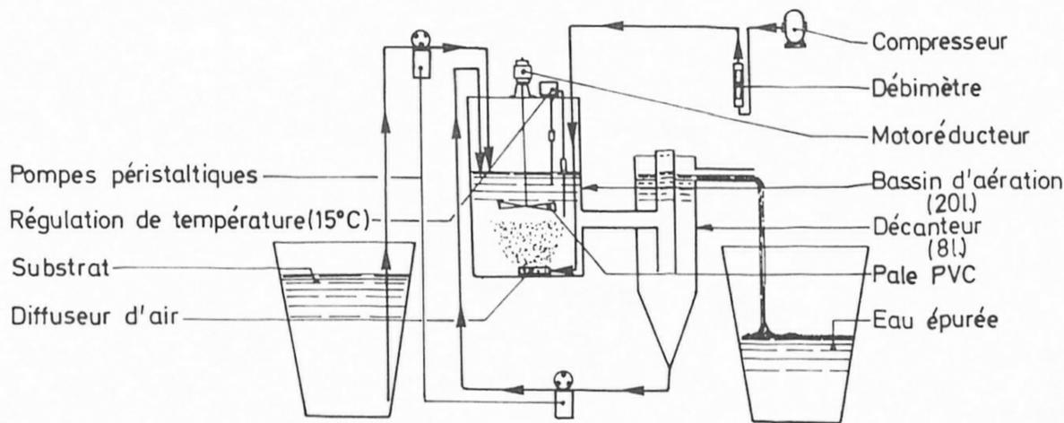
Fig. 4. Schéma du pilote de boues activées utilisé en laboratoire
