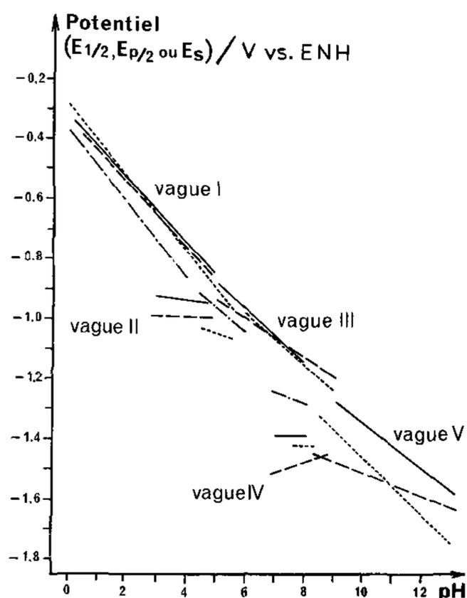
Fig. 1. Réduction électrochimique de la pyrimidine en solution aqueuse: influence du pH sur les potentiels relevés par polarographie classique sur goutte de mercure à stillation libre (—)<sup>1-4</sup>, par polarographie à tension alternative surimposée (---)<sup>5,6</sup> et par voltamétrie sur goutte de mercure pendante (.....) à 0.026 V s<sup>-1</sup><sup>6</sup> et sur disque de graphite immobile (-.-.-) à 0.060 V s<sup>-1</sup><sup>6</sup>.
