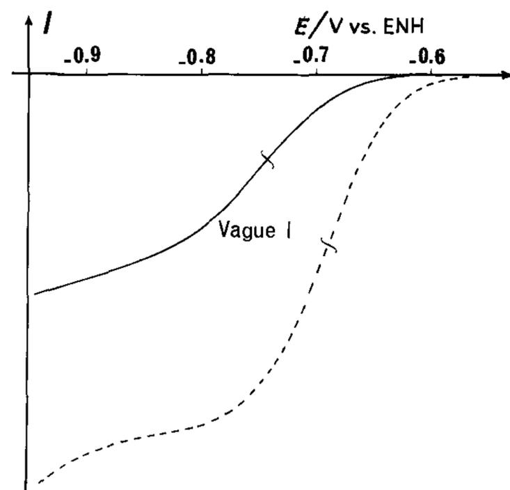
Fig. 10. Effet de la nature du matériau d'électrode sur la réduction de solutions aqueuses  $10^{-2} M$  en pyrimidine à pH 3.56 (tampon formiate). Polarographie à stillation commandée (----) et voltamétrie sur disque de carbone vitreux tournant (—).
