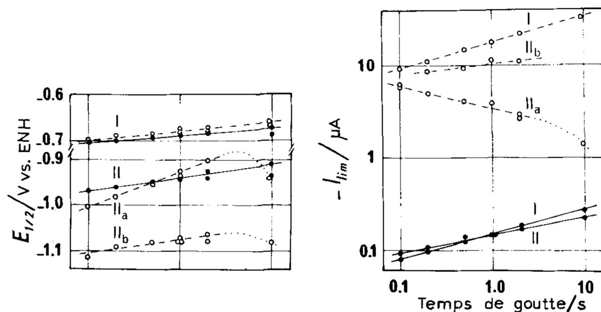
Figs. 6 et 7. Influence de la fréquence de chute des gouttes de mercure sur la réduction de la pyrimidine par polarographie à stillation commandée. Solutions  $10^{-4}$  M (●—●) et  $10^{-2}$  M (○—○) en pyrimidine dans un tampon formiate (pH 3.56). Conditions polarographiques: capillaire No. 10, 35.0 cm de mercure,  $25.0 \pm 0.2^\circ\text{C}$ .
