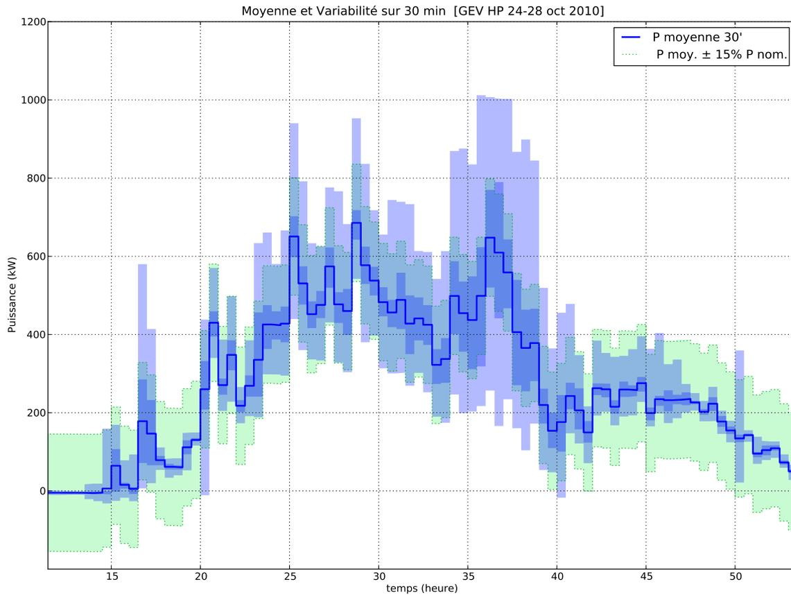
FIGURE 3 – Illustration de la variabilité de production éolienne
