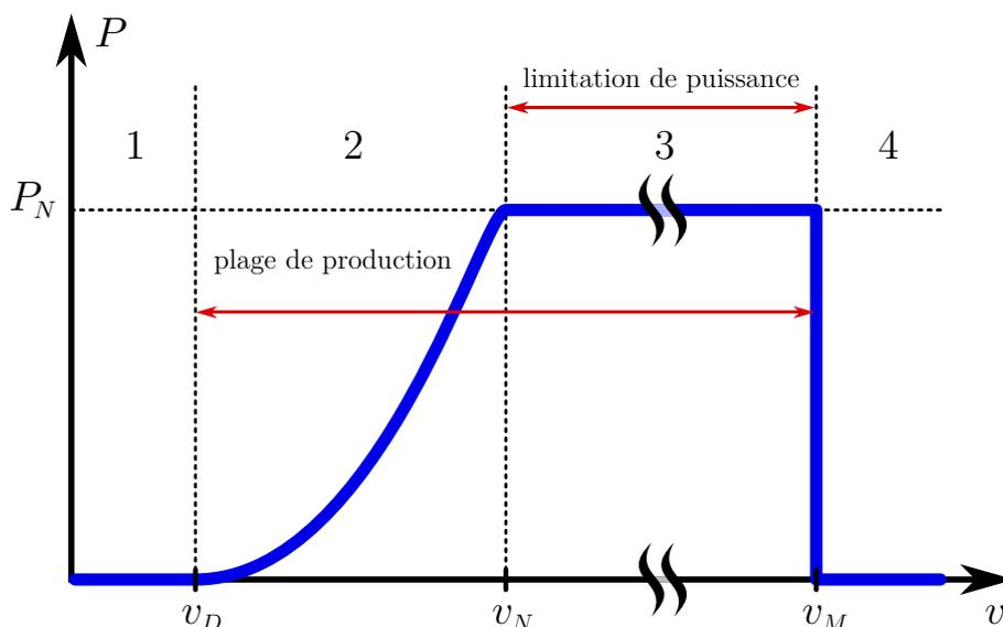
FIGURE 7 – Courbe de puissance d'une éolienne
