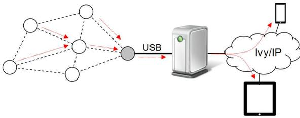
**Figure 11 : Topologie d'interconnexion réseau de capteurs sans fil/Ivy**
