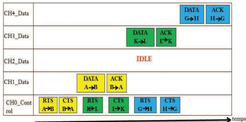
Figure 3 : principe du canal de contrôle dédié
