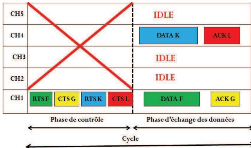
Figure 4 : principe de fonctionnement de *split phase*
