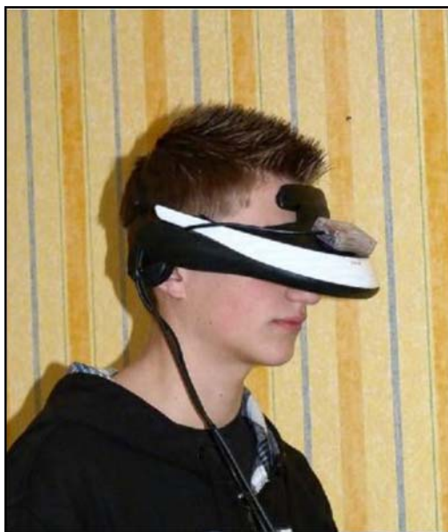
Fig. 2 Le visiocasque est relié à l'ordinateur portable et au système de capture de mouvement.
