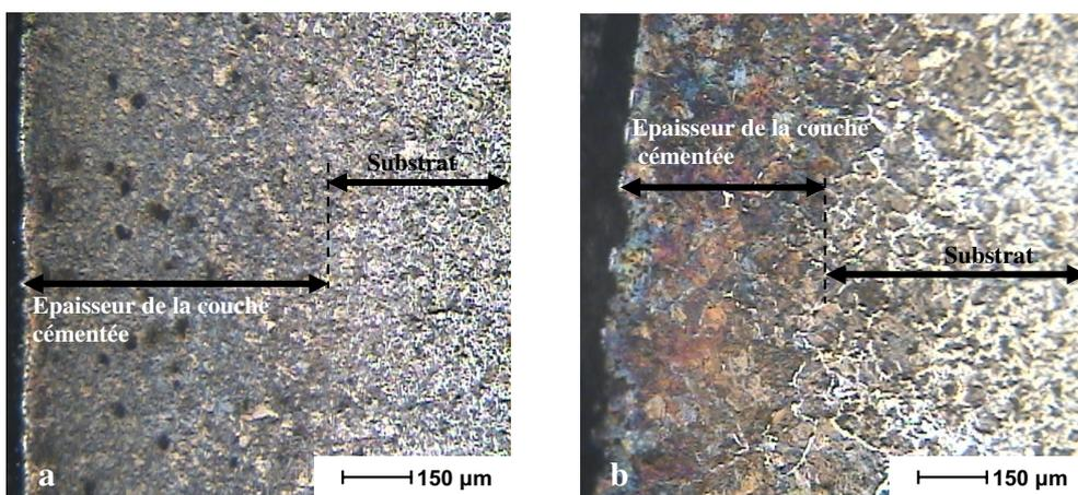
**Fig. 4.** Analyse métallurgique des aciers cimentés, (a) 16Mn5, (b) XC18. Durée de cémentation : 4 h.
