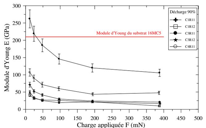
**Fig. 11.** Variation du module de Young des dépôts réalisés en fonction des différentes charges maximales appliquées.
