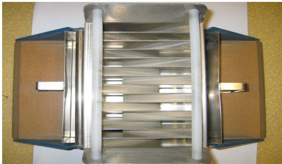
**Photo 1** : échantillonneur à grains © (R. Gosse 2007)
