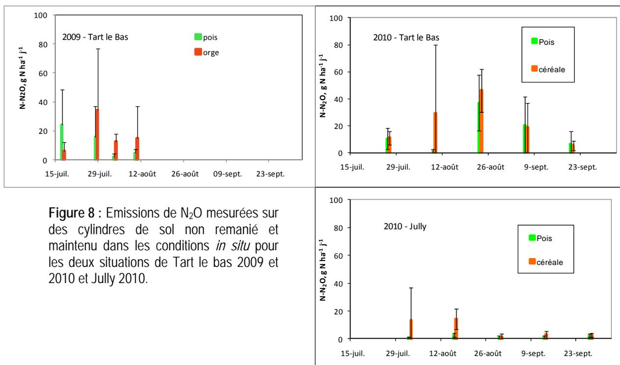
**Figure 8 :** Emissions de  $N_2O$  mesurées sur des cylindres de sol non remanié et maintenu dans les conditions *in situ* pour les deux situations de Tart le bas 2009 et 2010 et Jully 2010.
