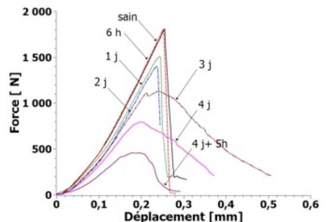
Figure 6 : comportement en compression des éprouvettes partiellement dégradées.
