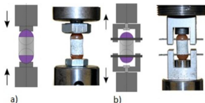
Figure 2 : Schémas et photos des supports pour l'essai de compression (a) et de traction (b).
