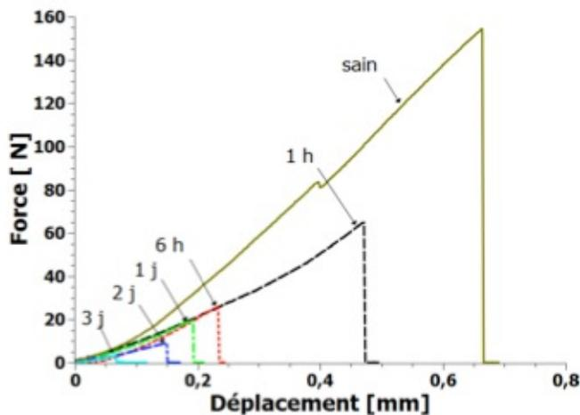
Figure 7 : comportement en traction des éprouvettes partiellement dégradées.
