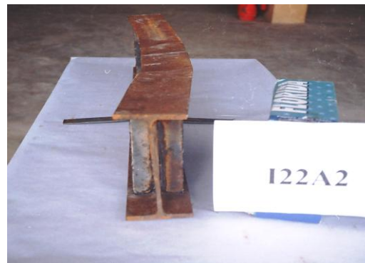
Figure 8. Mode de ruine pour le spécimen I22A2 avec 2 raidisseurs sur appuis.
