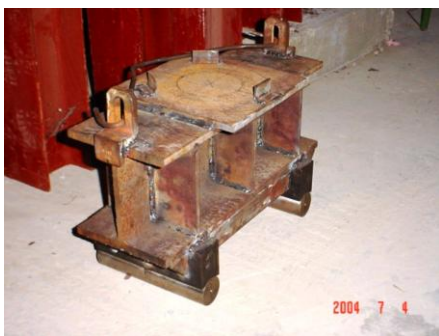
Figure 4. Poutre de charge.
