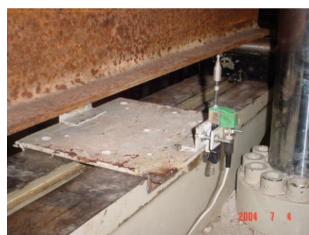
Figure 5. Dispositif de fixation des capteurs déplacement.
