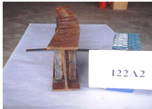
**Figure 8.** Mode de ruine pour le spécimen I22A2 avec 2 raidisseurs sur appuis.
