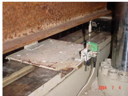
Figure 5. Dispositif de fixation des capteurs déplacement.
