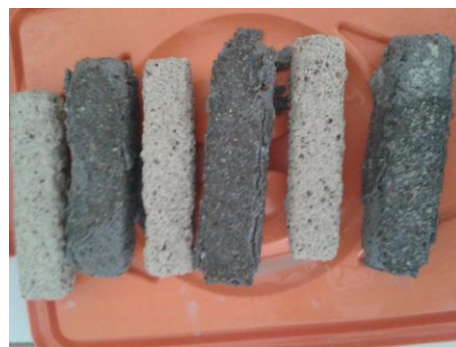
Figure 9. Fissurations du mortier dans l'acide sulfurique dues à la formation de produits expansifs
