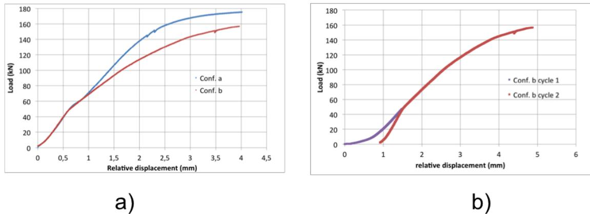
**Figure 3.** Courbes réponse force-déplacement : a) configuration a ; b) configuration b.
