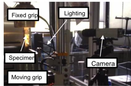
**Figure 2.** Montage expérimental
