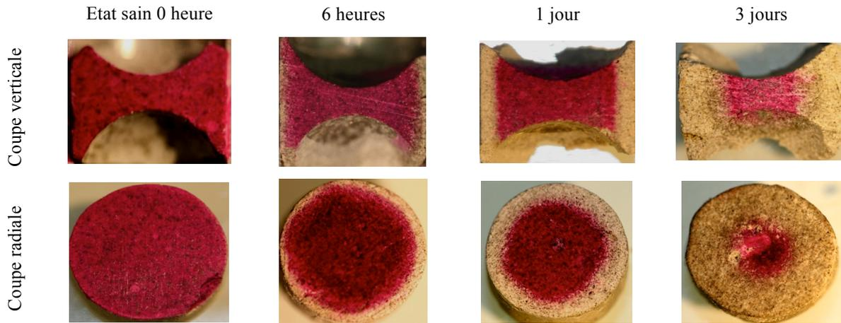
**Figure 6.** Mise en évidence de l'épaisseur dégradée dans le sens radial au moyen de la phénolphthaléine au cours du temps. Vues en plan vertical (images du haut) et en plan horizontal (images du bas).
