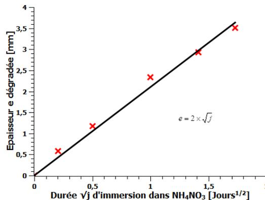
**Figure 7.** Evolution de l'épaisseur dégradée dans le sens radial en fonction de la durée d'immersion.
