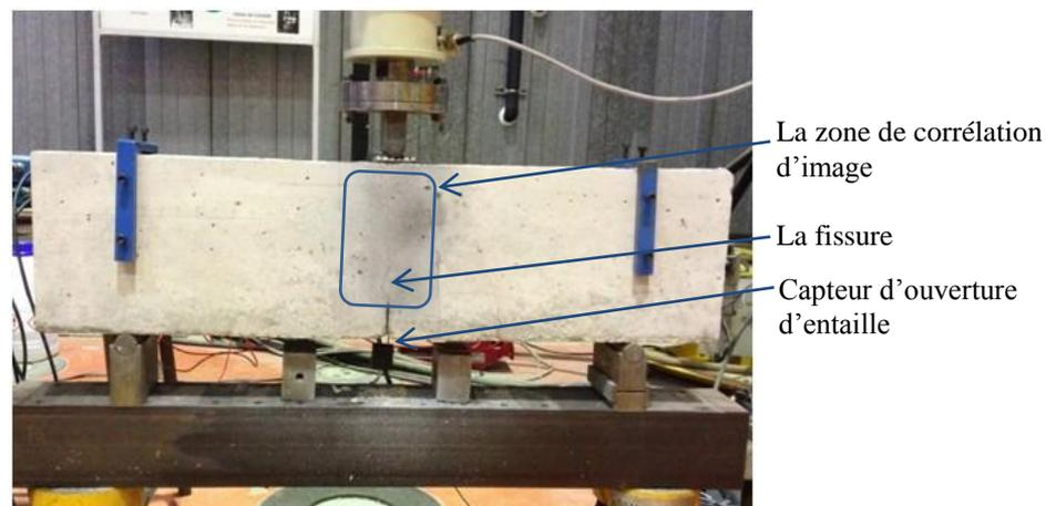
**Figure 1.** Dispositif d'essais de flexion trois points.
