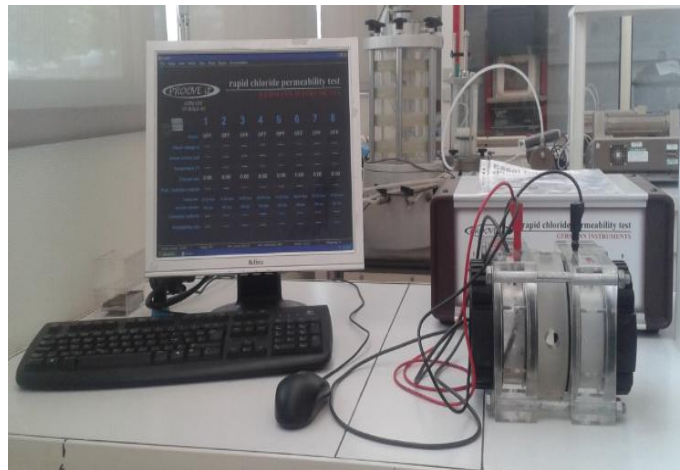
Figure 2. Dispositif expérimental de la diffusion des ions chlorures.
