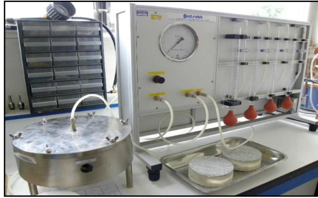
Figure 3: Mesure de la perméabilité à l'air selon la méthode Cembureau.
