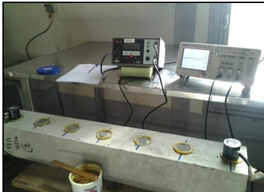
Figure 1. Dispositif pour la mesure des paramètres des ondes de surface.
