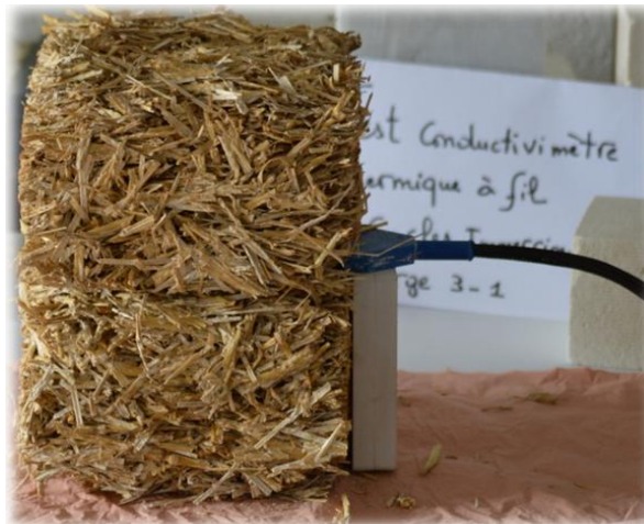
Figure 2. Mesure de la conductivité thermique en utilisant la méthode du fil chaud.
