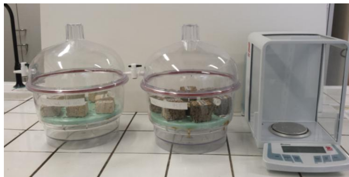
Figure 3. Détermination de l'isotherme de sorption par la méthode des solutions salines (suivi de prise ou de perte de masse).
