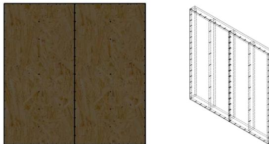
**Figure 1.** Vue de face d'un mur à ossature bois (à gauche) et vue en perspective de l'ossature (à droite)
