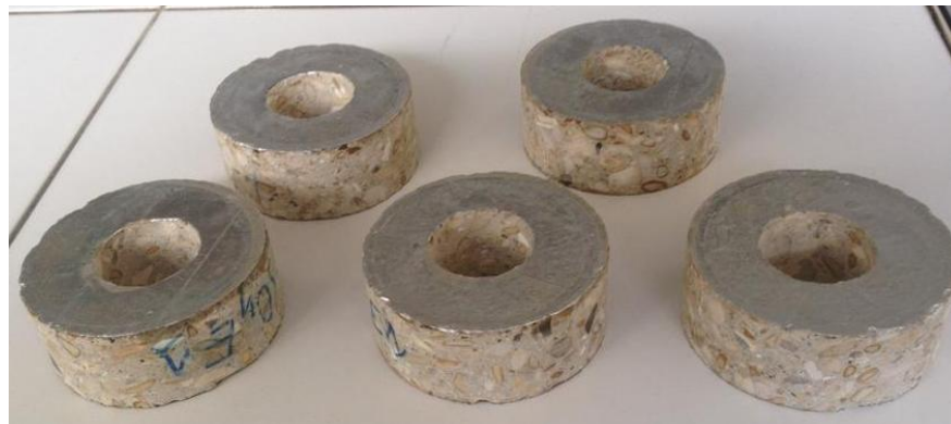
Figure1. : Éprouvette de l'essai de perméabilité
