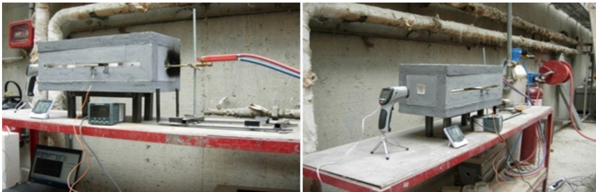
Figure 4. Dispositif expérimental de simulation expérimentale a) face à la flamme ; b) face froide
