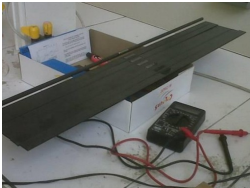
Figure 5. Mise en place de jauges de déformation sur les plats ou jonc de carbone. enregistrées automatiquement par systèmes d'acquisitions.
