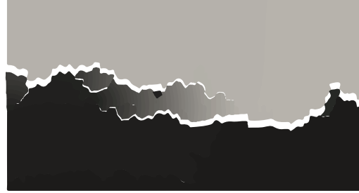
(b) faciès de fissuration en traction pour \epsilon = 3.0 \times 10^{-3}
