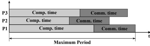
FIGURE 2 – Calcul de la période maximale d'un processeur
