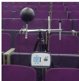
Fig. 4 Station de confort et ses instruments
