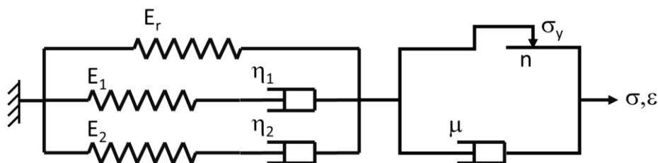
**Figure 4 :** Représentation du modèle rhéologique élasto-viscoplastique utilisé.
