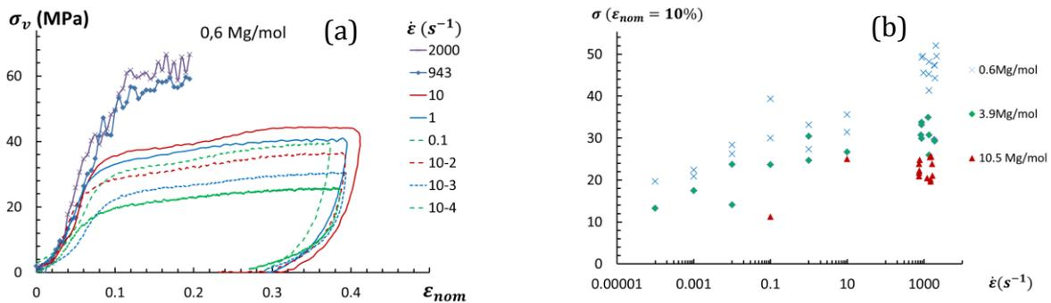
**Figure 3 :** (a) Courbes contrainte/déformation dans le cas d'échantillons de masse moléculaire 0.6 Mg/mol frittés à 200 °C pendant 2 h allant du quasi statique (sur une machine de compression hydraulique MTS810) jusqu'à des essais par barres d'Hopkinson (effectués au PIMM par Nicolas Ranc), (b) contrainte relevée à 10 % de déformation en fonction de la vitesse de déformation pour différentes masses moléculaires.
