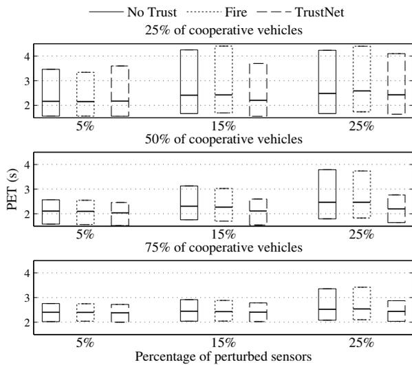
FIGURE 5 – Distributions des PET (médiane, 1<sup>er</sup> et 9<sup>ème</sup> déciles) pour trois variantes de modèles de confiance. Du haut vers le bas : augmentation du % de véhicules équipés. De gauche à droite : augmentation du % de capteurs défaillants.
