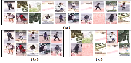
FIGURE 2 – Résultat de l'étape de prédiction : (a) Détections du détecteur générique appliqué sur les images de la base CUHK_Square. Résultat de l'étape de mise à jour : (b) Exemples classés positifs, (c) Exemples classés négatifs. Les échantillons englobés par un rectangle rouge indiquent un échec de classification
