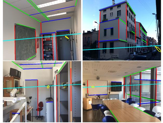
FIGURE 6 – Quelques photos du jeu de données avec leurs segments annotés à la main (en rouge, vert, bleu). En cyan : la ligne d’horizon calculée à partir des données inertielles. Les polygones des régions d’incertitude des points de fuite associés aux segments verts sont représentés en jaune. Sur la première ligne, les lignes d’horizon n’intersectent pas les polygones jaunes à cause du biais des données inertielles.
