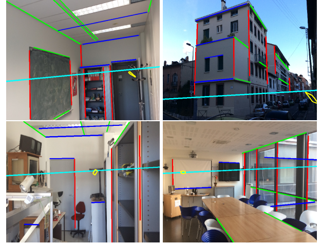
FIGURE 6 – Quelques photos du jeu de données avec leurs segments annotés à la main (en rouge, vert, bleu). En cyan : la ligne d’horizon calculée à partir des données inertielles. Les polygones des régions d’incertitude des points de fuite associés aux segments verts sont représentés en jaune. Sur la première ligne, les lignes d’horizon n’intersectent pas les polygones jaunes à cause du biais des données inertielles.
