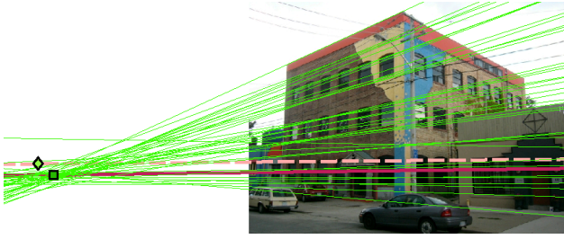
FIGURE 2 – Cette figure montre les points de fuites et les lignes d’horizons fournis par le York Urban Database, avant et après orthogonalisation. Un des points de fuite estimé par [11] est représenté par un carré vert. La ligne d’horizon en rouge est calculée par la même méthode. Le point de fuite vert en forme de losange et la ligne d’horizon en pointillé rose sont obtenus après orthogonalisation de la solution précédente. On peut observer que ce dernier est situé relativement loin du lieu des intersections des différentes droites (en vert) de la scène.
