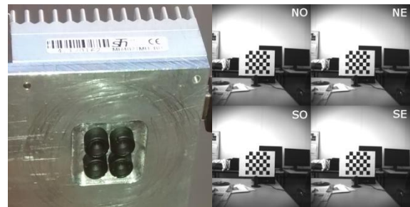
Figure 1 : (a) Caméra avec 4 mini-lentilles. (b) Sous-images correspondantes (Nord-Ouest, Nord-Est, Sud-Ouest et Sud-Est).
