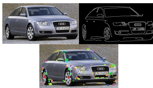
Fig. 4 : Première ligne, l'image à tester et sa carte de contours sur laquelle va être effectuée la détection. Deuxième ligne, les parties détectées. Chaque couleur correspond à une partie.
