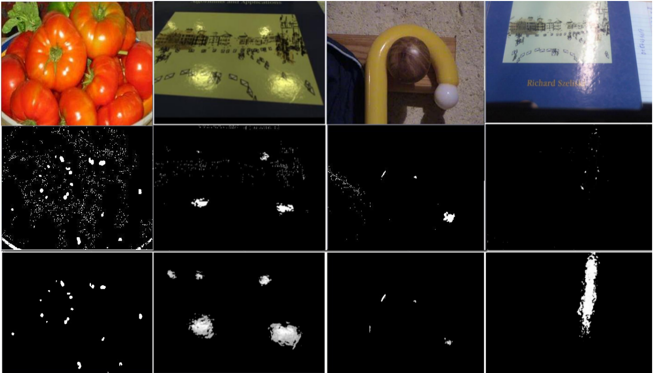
FIGURE 8 – Résultats de la détection de spécularités de l’approche d’Arnold et al. [1] (au milieu) en comparaison avec notre méthode (en bas).
