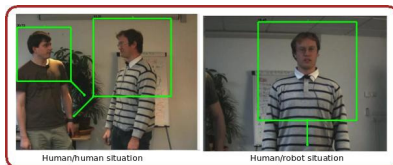
FIGURE 2 – Résultat de notre classifieur en situation d’interaction. Les flèches proéminentes indiquent l’orientation du buste.
