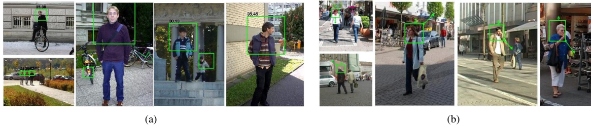
FIGURE 8 – Quelques illustrations de détections de buste (a), et d'estimations d'orientation (b) provenant, respectivement, des bases de données Inrialite et TUD Multiview.
