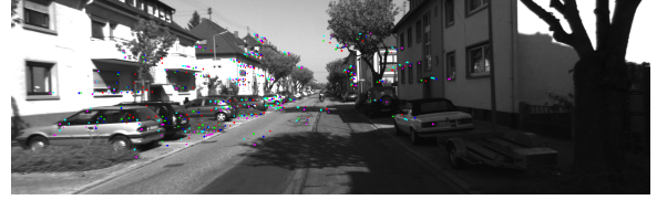
FIGURE 4 – Exemple d'erreurs de reprojection des points 3D après AF, chaque couleur fait référence aux erreurs de reprojection dans une caméra de la fenêtre glissante (5 caméras)
