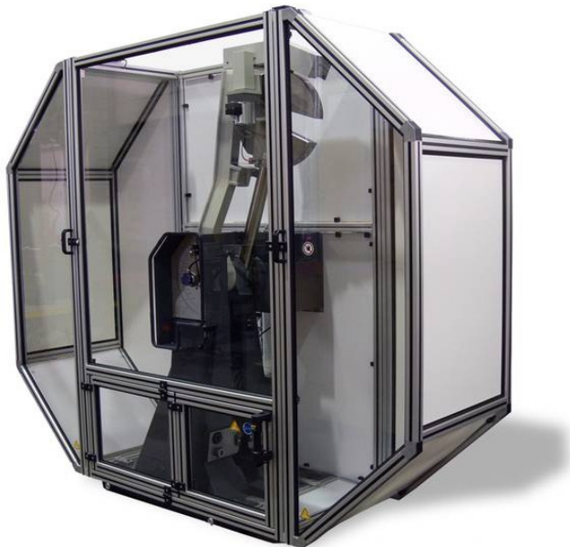
Mouton de Charpy 750 joules, dispositif utilisé pour la mesure de la résilience des aciers (tiré du cours Produits Procédés et Matériaux de X. Pessoles 2013)
