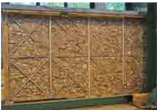
Ci-dessus et à droite, séries de tests avec le mini mur de réaction, réalisées sur la cellule élémentaire et avec différents types de remplissage
