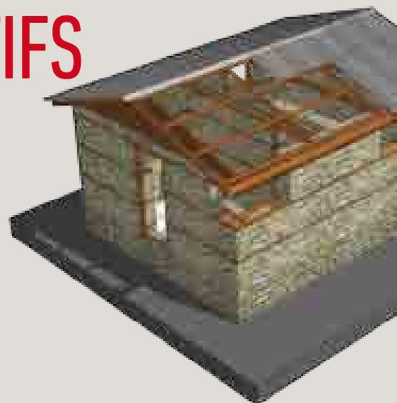
Ci-dessous, les modèles proposés dans les zones montagneuses du projet ENH-PRESTEN sont en maçonnerie de pierre chaînée par des échelles de bois horizontales disposées tous les 60 cm
