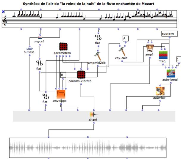
**Figure 3.** reconstitution de l'air de « La reine de la nuit » avec *Chant-lib*. Différentes fonctions, dont les règles *auto-bend* et *auto-bw*, sont utilisées pour régler les paramètres formantiques. Le patch *paramètres* renferme un ensemble de valeurs appliqués note par note pour les paramètres d'enveloppe et de vibrato.
