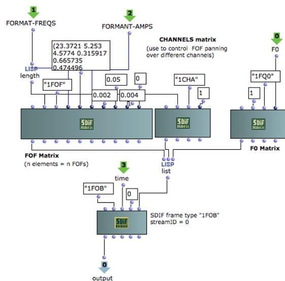
**Figure 5.** Génération d'un *frame* CHANT à l'aide des outils SDIF de OpenMusic. Un objet *SDIFFrame* de type "1FOB" (pour *FOF bank*) est créé contenant une valeur de fréquence fondamentale (matrice *F0*), les paramètres des différents formants (matrice *FOF*), ainsi que la distribution de la sortie des générateurs de FOFs sur un nombre donné de canaux (matrice *Channels*).
