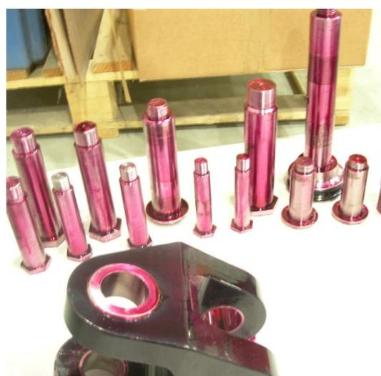
**Figure 11 : Méthode par Ressuage de pièces pour Orange II**
