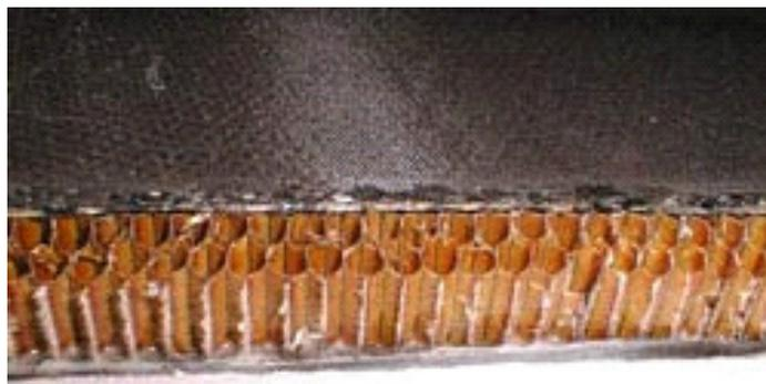
**Figure 2 : Structure sandwich, peaux carbone époxy et âme Nomex®**
