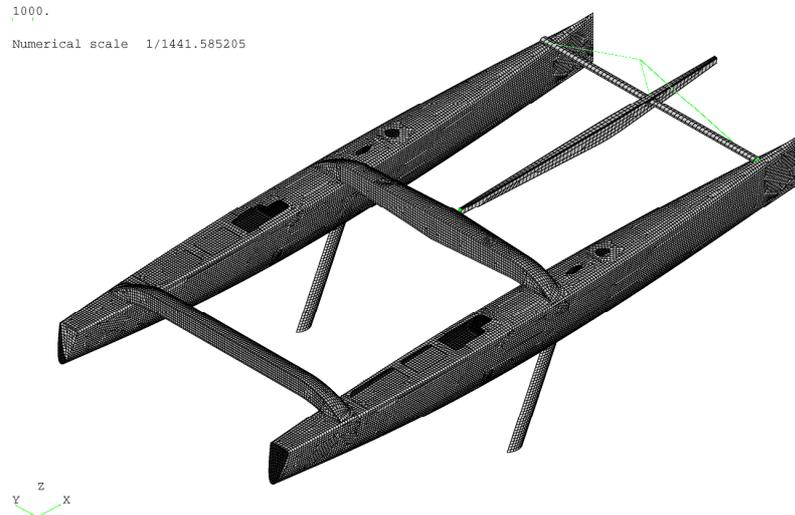
**Figure 6 : Modèle éléments finis coques du voilier Orange II**
